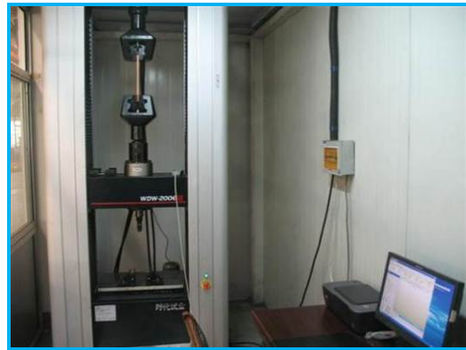
200KN Tensile Tester 拉力试验机
