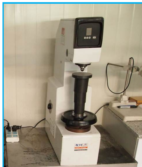
250kgf Brinell hardness Tester 布氏硬度计
