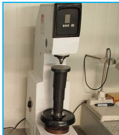
Brinell Hardness tester 62.5kgf 布氏硬度计
